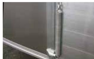
Rampenhebehilfe mit Spiralfeder
